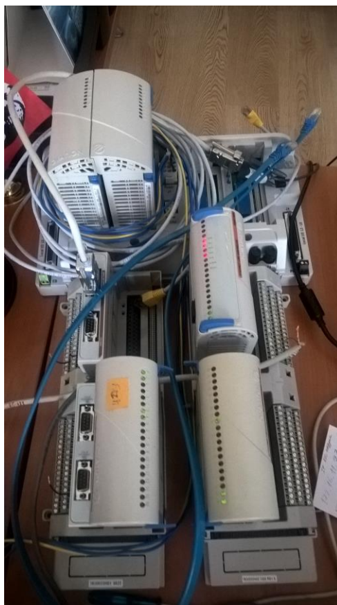
Рисунок 3 - Имитатор ГРАМ во время полигонных испытаний в СО ЕЭС
